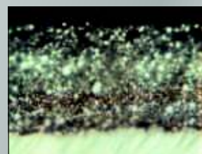
Abb. 3 Der gleiche Test wurde mit einer Epoxy-Zinkstaubfarbe durchgeführt. Der Goldstaub bleibt unverändert zwischen den beiden Farbschichten. Der Goldfilm ist deutlich zu erkennen. Dieses zeigt, dass die beiden Schichten keine homogene Schicht bilden.
